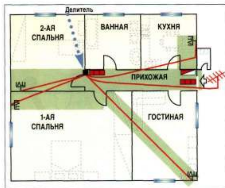
1. Определение трассы кабельных труб и места установки встроенных коробок для телевизионной системы
