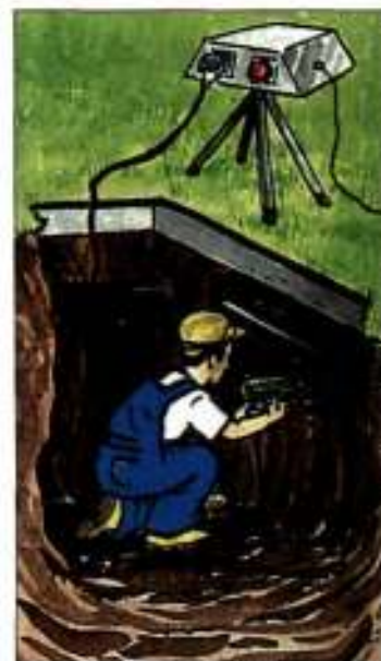
11. В узких местах с проводящей средой питание передвижных и переносных устройств может осуществляться от сети через предохранительный трансформатор с выходным напряжением 24 В
