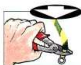
5. Надеть наконечник на кабель и зажать его пассатижами
