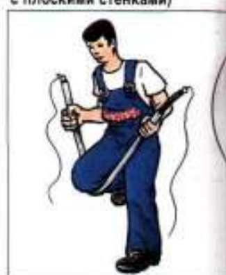
7. Осуществлять гибку труб использованием предусмотренных для этой цели пружин, обеспечивающих получение угла сгиба 90°
