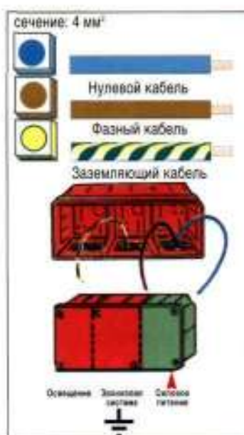
2. Выбор кабелей для стояка системы силового питания. Пример ввода кабелей в ответвительную коробку
