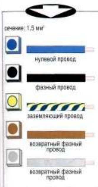
5. Тип кабелей, используемых для выполнения системы освещения
