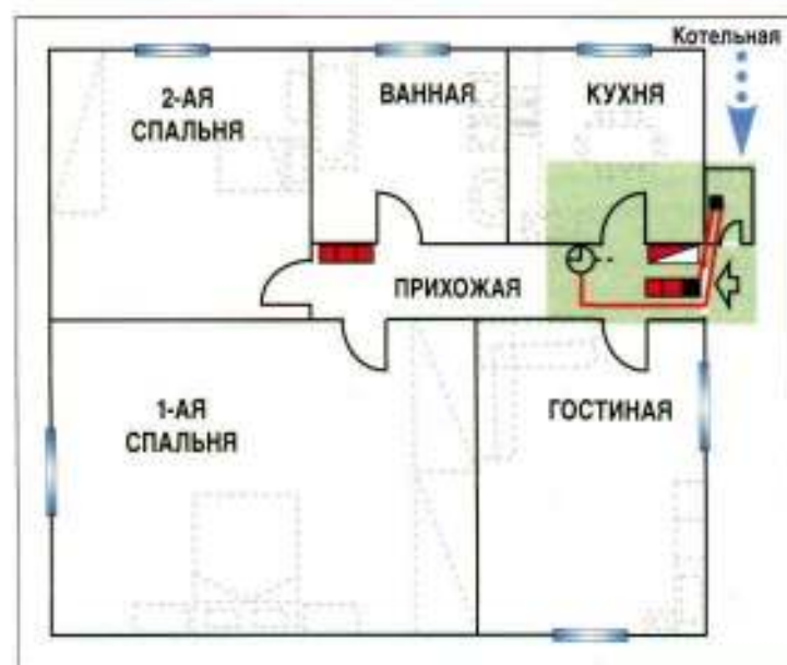
1. Определение места установки встроенных коробов и прокладки кабельных труб для системы регулирования температуры отопления
