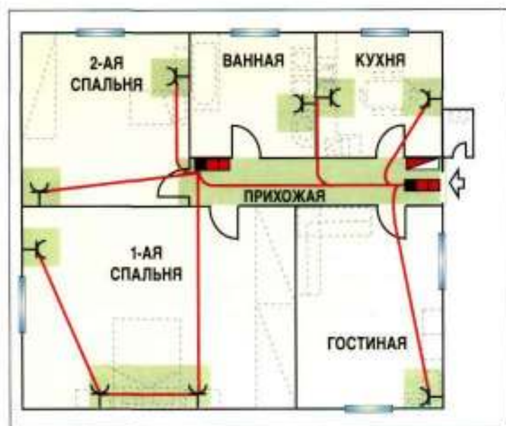
1. Определение трассы кабельных труб, места установки коробок и штепсельных розеток 10 А
