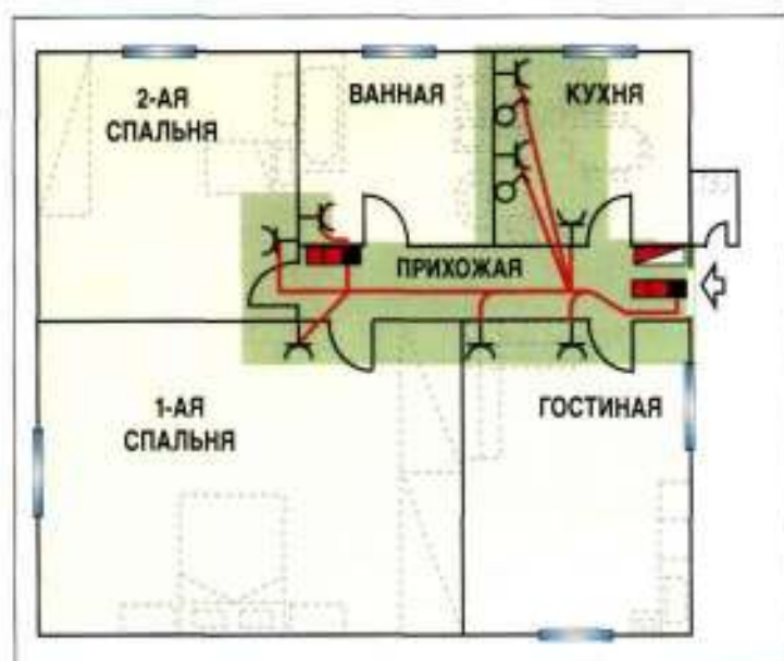
1. Определение трассы кабельных труб и места установки встроенных коробов под штепсельные розетки 10 А
