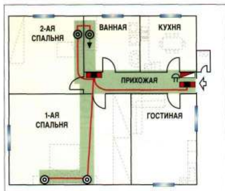
1. Определение трассы кабельных труб и места установки встроенных коробок для схемы включения
