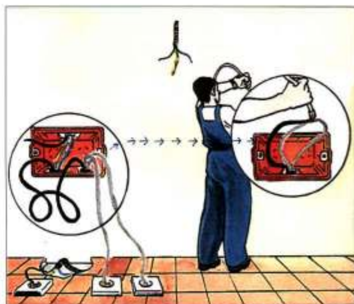
6. Протяжка кабелей при помощи троса для соединения двух переключателей
