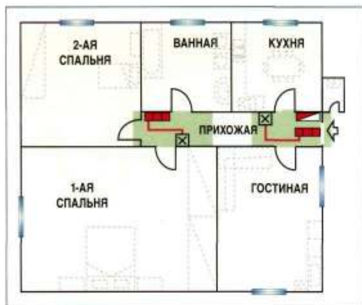
1. Определение места установки встроенных коробов и прокладки кабельных труб для системы аварийного освещения
