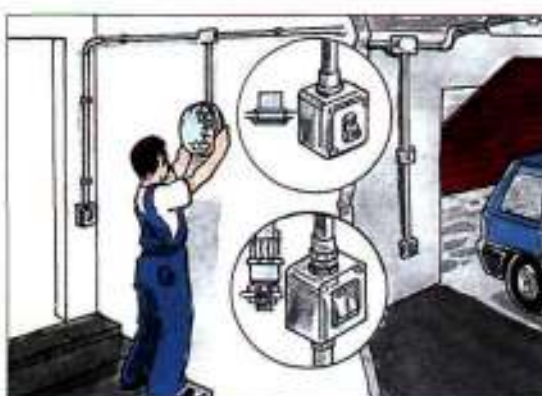
6. Пример открытой прокладки кабельных труб
