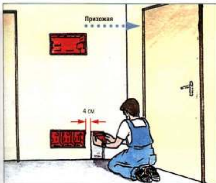
3. Пример установки входной ответвительной коробки для телефонной линии в прихожей
