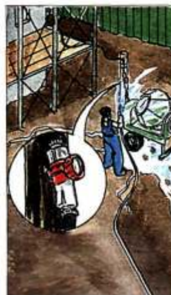
9. Передвижные штепсельные розетки, установленных в местах использования струйной воды, должны иметь степень защиты IP 67
