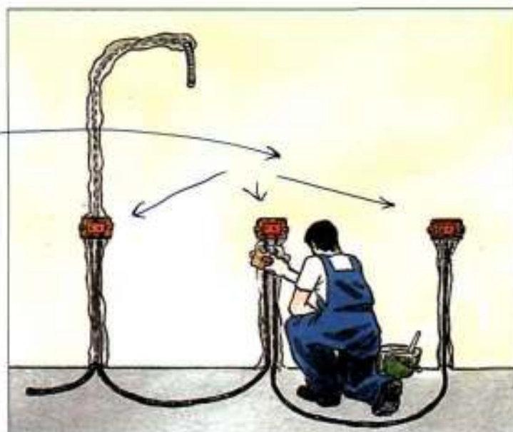
2. Заделывание канавки цементным раствором
