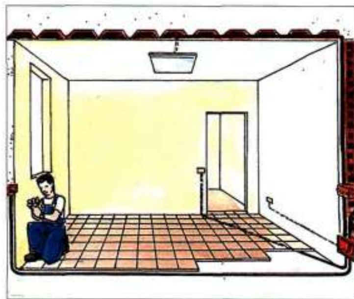
4. Пример встроенной прокладки жестких кабельных труб в помещении офиса
