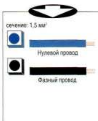
2. Выбор кабелей для системы аварийного освещения
