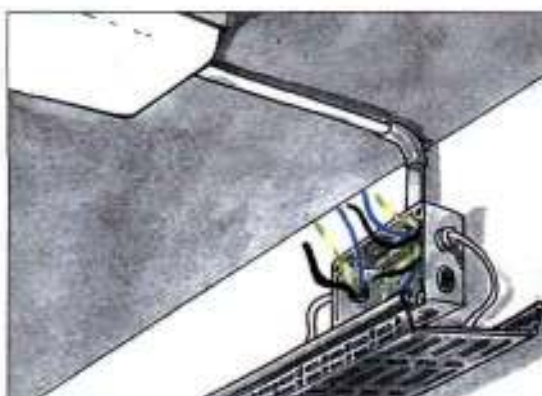
10. Пример соединения лотка (или площадки) со световым прибором
