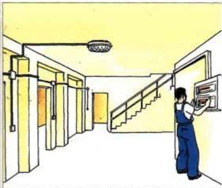
3. Пример "смешанной" (трубы и короба) открытой проводки в коридоре
