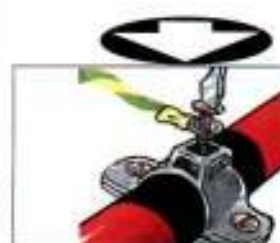
6. Подсоединить кабель заземления к трубному хомуту
