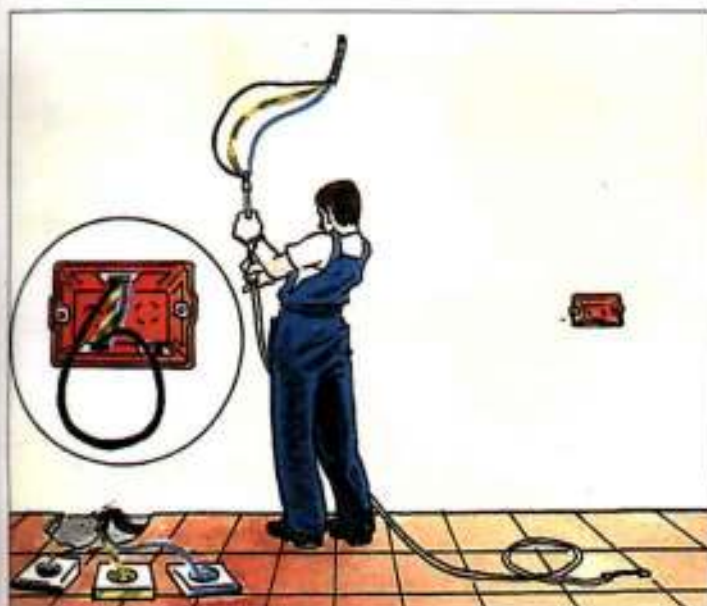
4. Протяжка кабелей при помощи троса до точки установки светового прибора
