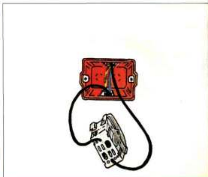
6. Подключение кабелей черного цвета к выключателю
