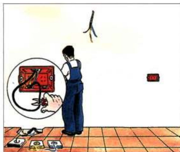
5. Вывод и перерезание кабеля черного цвета
