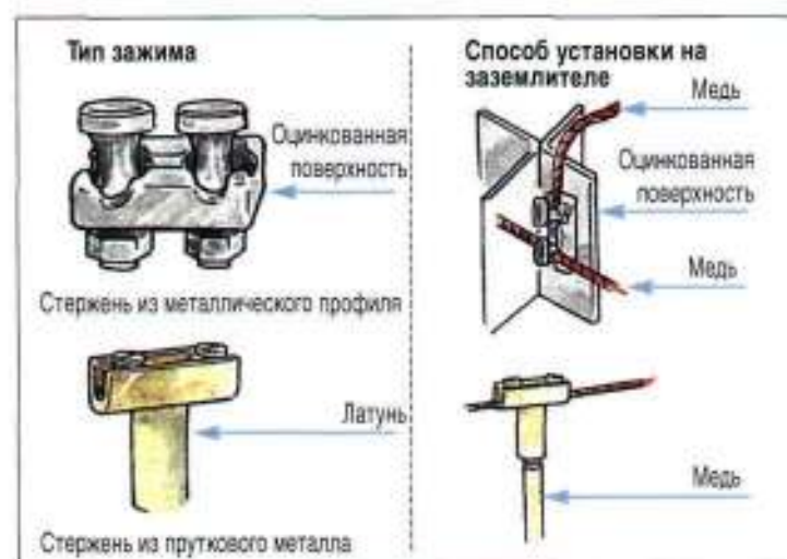
5. Тип и способ установки зажимов на заземлителях
