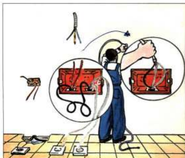
6. Протяжка кабелей при помощи троса для соединения реверсирующего переключателя с групповым выключателем
