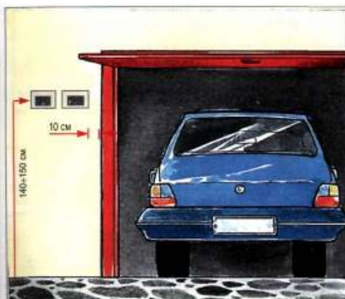
6. Примерные отметки для установки штепсельных розеток и выключателей освещения в гараже
